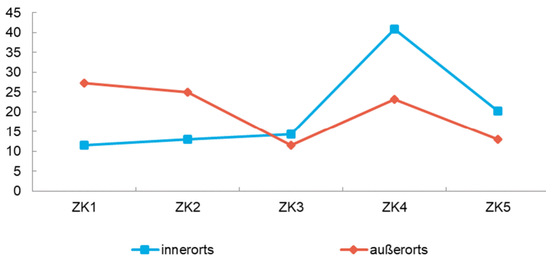
Zustandsverteilung der Fahrbahnen StädteRegion Aachen innerorts/außerorts in Prozent 2019
